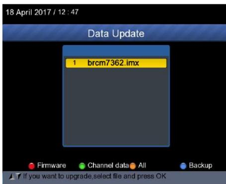
Déplacez le curseur sur le fichier IMX et appuyez sur OK. L'appareil commence la mise à niveau. Après la mise à niveau, l'appareil s'éteint automatiquement. Vous pouvez rallumer l'appareil.
