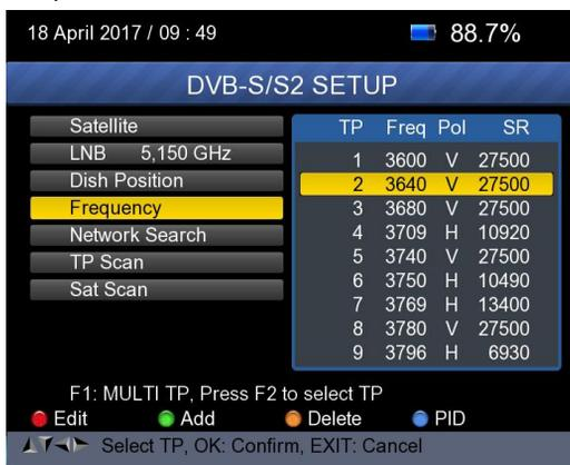
**Edit** : Appuyez sur <Red (0 / 22K)> pour modifier la fréquence à l'aide des touches numériques. Appuyez sur les boutons UP / DOWN pour sélectionner "Pol". Appuyez sur <OK> pour confirmer l'opération et enregistrer le résultat.
