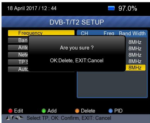
**Informations PID** : Appuyez sur <Bleu (PID)> pour vérifier les informations PID de la fréquence.
