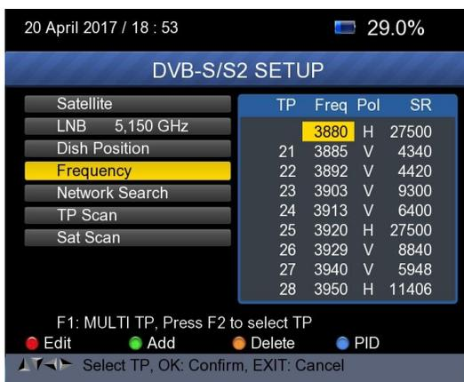
**Add** : Appuyez sur la touche <Grün (H / V)> pour ajouter une fréquence à l'aide des touches numériques. Appuyez sur les touches UP / DOWN pour sélectionner "Pol". Appuyez sur <OK> pour confirmer l'opération et enregistrer le résultat.
